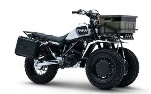
ヤマハのTMW 3輪車 左右独立制御のフロント2輪でさま ざまな路面状況に対応する走破性
