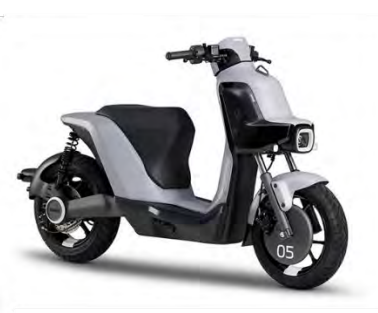
ヤマハのELOVE 2輪車 二輪車安定化支援システム「AMSAS」 を搭載した極低速運転における転倒 不安や疲労を防止
