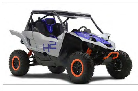
ヤマハのYXZ1000R (水素エンジン搭載) 4輪車 100%水素エンジンを搭載し たROV (四輪バギー)
