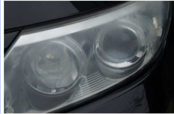
ヘッドライトの表面劣化
