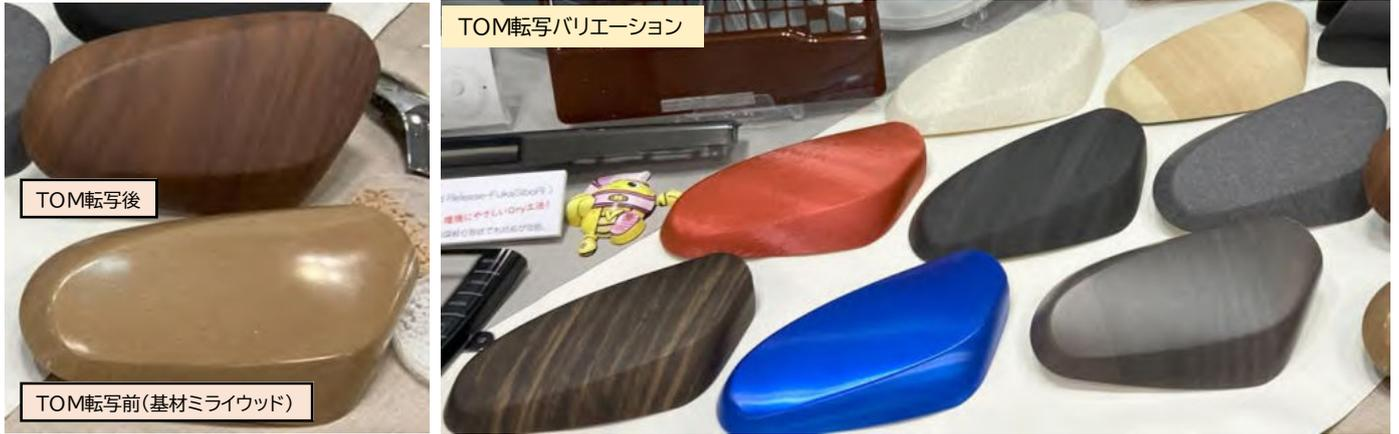
各種バイオ材への加飾 バイオ材料成形品への転写加飾(少量～大量生産まで)
