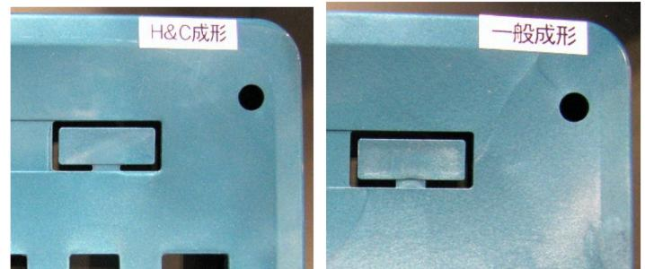
図6 富士精工によるウェルドレスメタリック成形品(左)と対照品(右)
